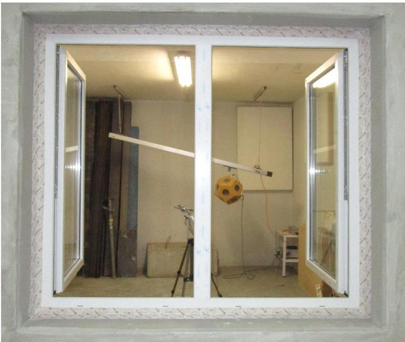
**Bild A.3.2** Ansicht Prüfobjekt geöffnetes Referenzfenster - Empfangsraumseite
