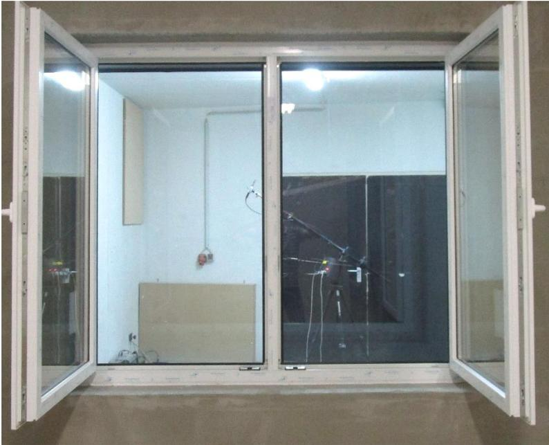
**Bild A.3.1:** Ansicht Prüfobjekt Schallschutzkasten mit geöffnetem Referenzfenster - Sende-
