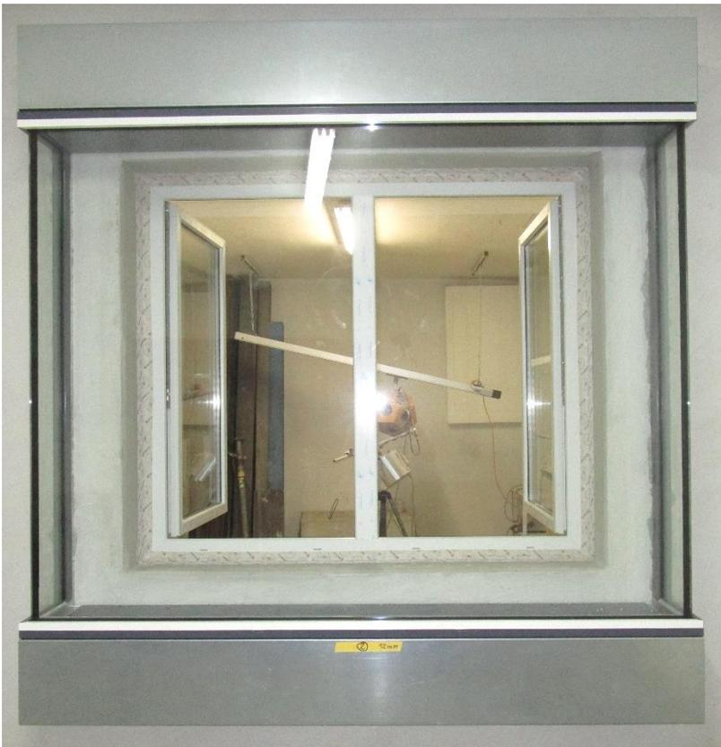
**Bild A.3.2** Ansicht Prüfobjekt Schallschutzkasten mit geöffnetem Referenzfenster - Emp-
