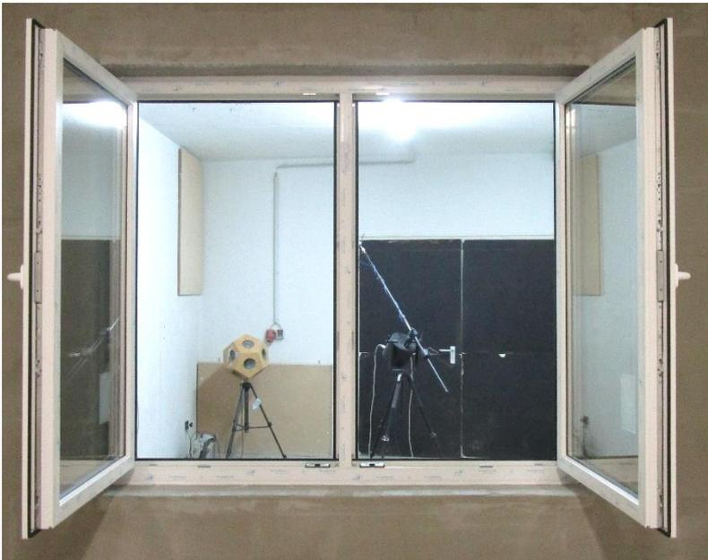
**Bild A.3.1:** Ansicht Prüfobjekt geöffnetes Referenzfenster - Senderraumseite
